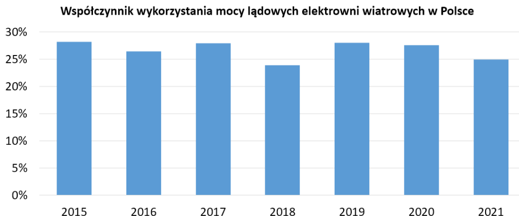
Ilustracja 1. Współczynnik wykorzystania mocy lądowych elektrowni wiatrowych w Polsce w kolejnych latach. Źródła: Moc zainstalowana farm wiatrowych, Rynek elektryczny w Polsce ; Praca KSE - generacja źródeł wiatrowych i fotowoltaicznych, Polskie Sieci Elektroenergetyczne .
